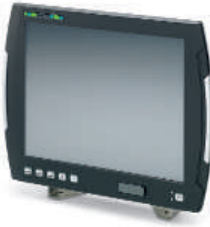
Панельный ПК со степенью защиты IP65 и дисплеем 38,1 см (15")
