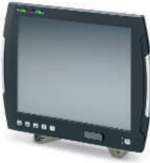
Панельный ПК со степенью защиты IP65 и дисплеем 30,7 см (12,1")
