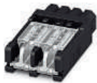
Штекер с прокалывающими контактами для проводов сечением до 0,14 мм 2 / AWG 26
